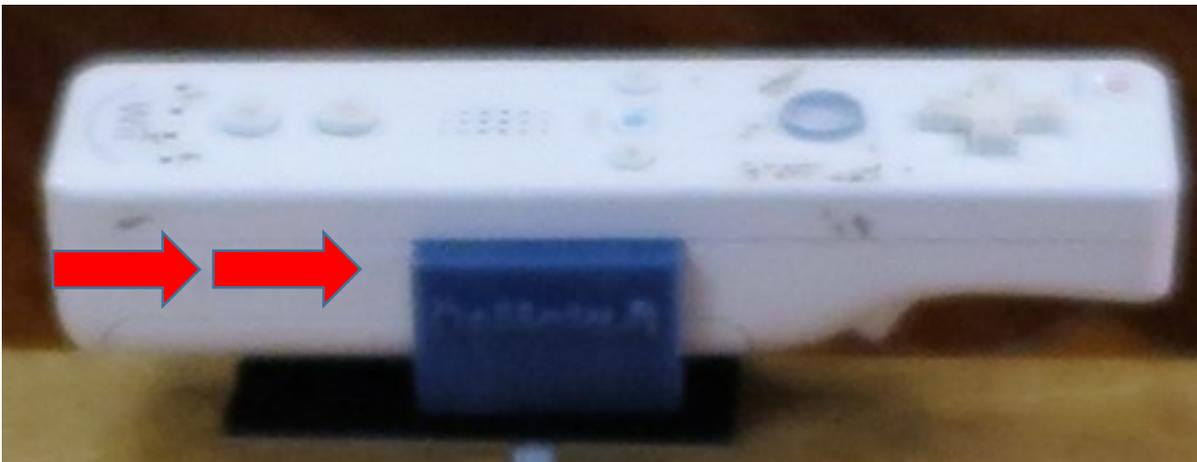
Il wiimote va inserito infilandolo attraverso le opportune guide fino a raggiungere il centro del Tracker DeMotu facendo in modo che la tavola propriocettiva in posizione parallela al terreno non restituisca nessuna traccia orizzontale sul display del software durante il funzionamento
